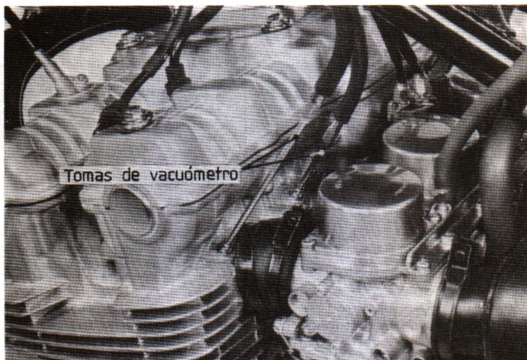
Figura 61. Colocación de las tomas de vacuómetro para la sincronización de las mariposas de todos los carburadores.
