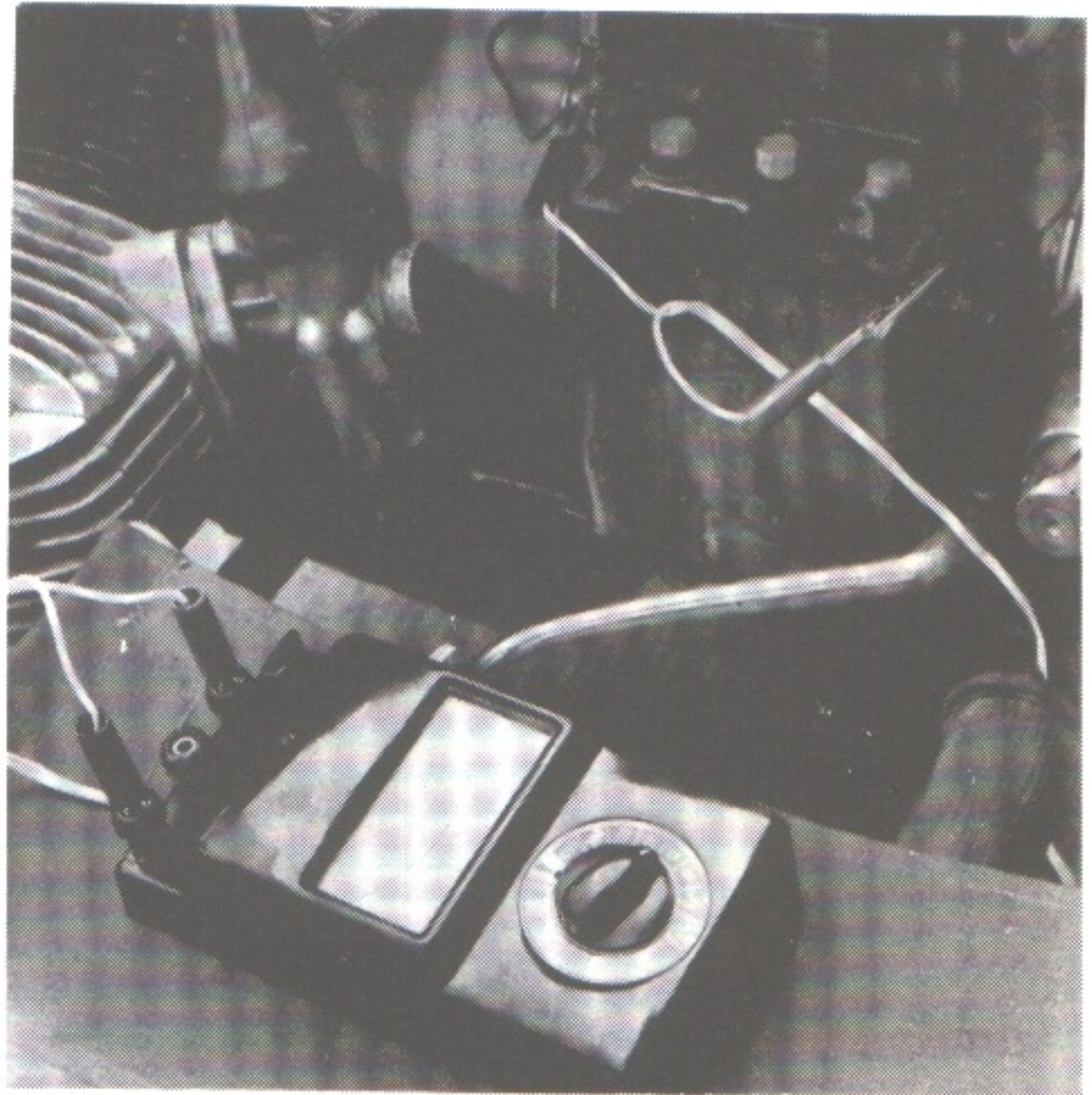
Figura 6. Así es en la realidad: el cable positivo se ha desconectado del terminal de la batería y se ha llevado al polo positivo del voltímetro.
