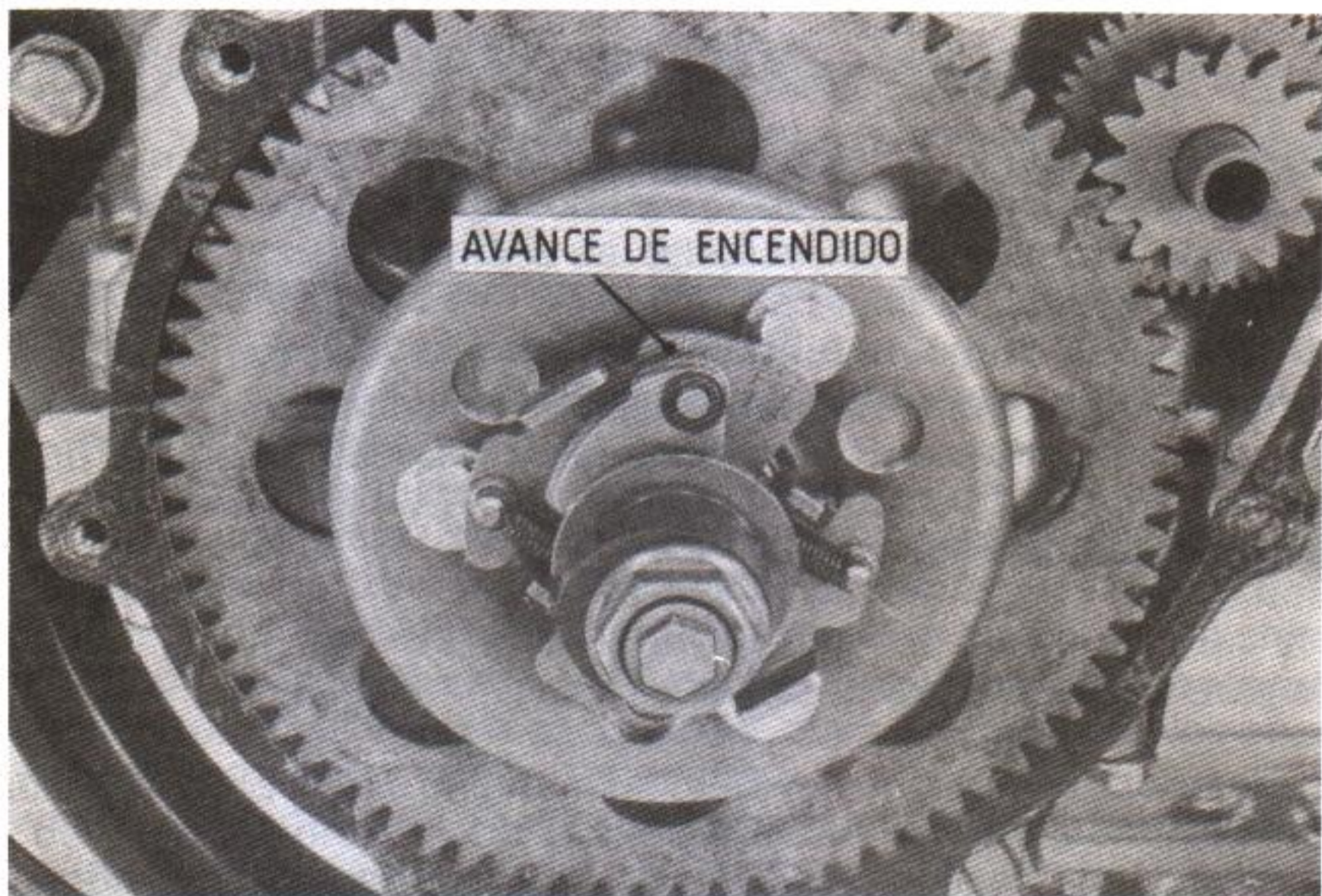
Figura 63. Una vez retirado el generador de impulsos nos queda a la vista el mecanismo del avance automático.
