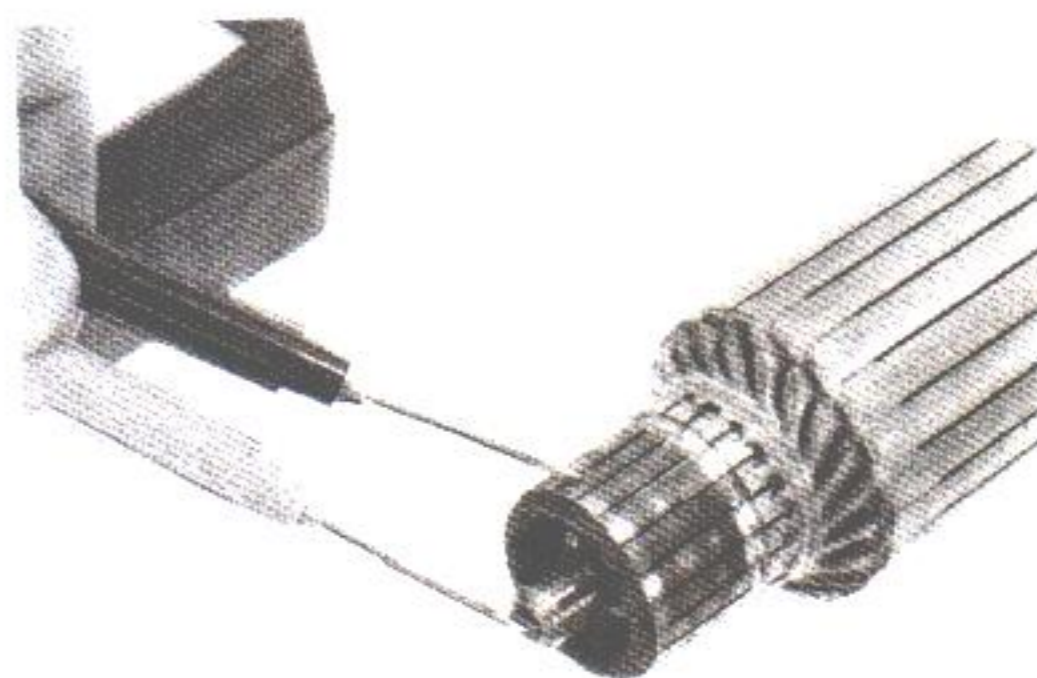
Figura 77. Comprobación del colector colocando las puntas de medir de un ohmímetro entre cada una de las delgas y masa.
