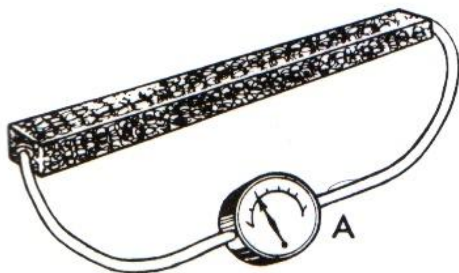
Figura 22. El ohmímetro (A) marca la resistencia de la barra de plata.
