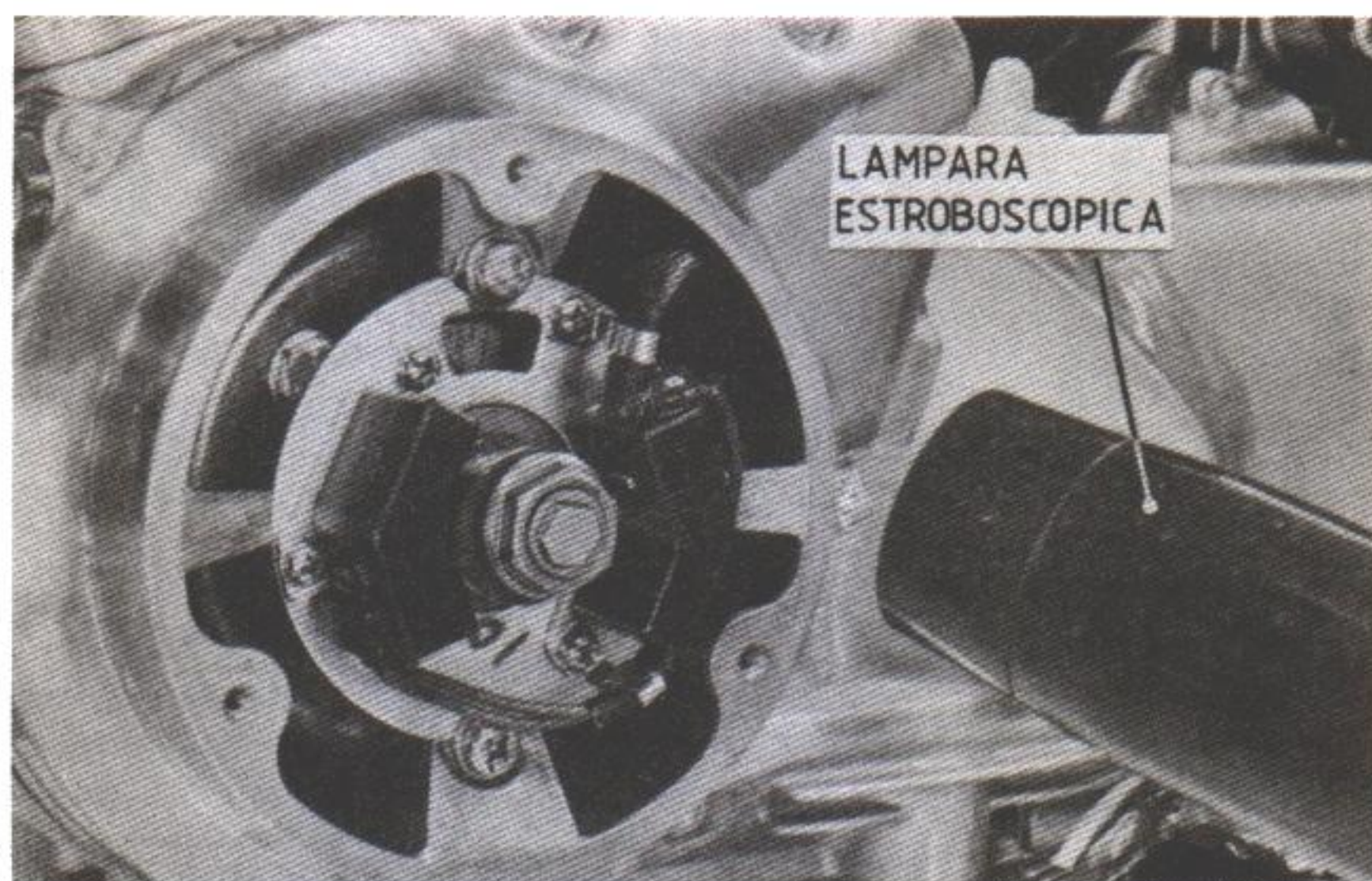
Figura 65. Comprobación de la puesta a punto con la ayuda de una pistola estroboscópica.
