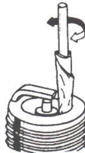
Figura 40. Limpieza de los electrodos con la ayuda de un cepillo de púas metálicas.
