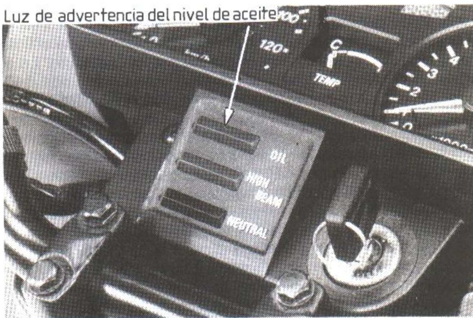
Figura 62. Luz indicadora del estado de llenado del depósito de aceite.
