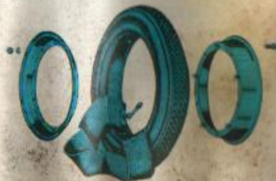
Fig. 30 Desmontaje del neumático.
