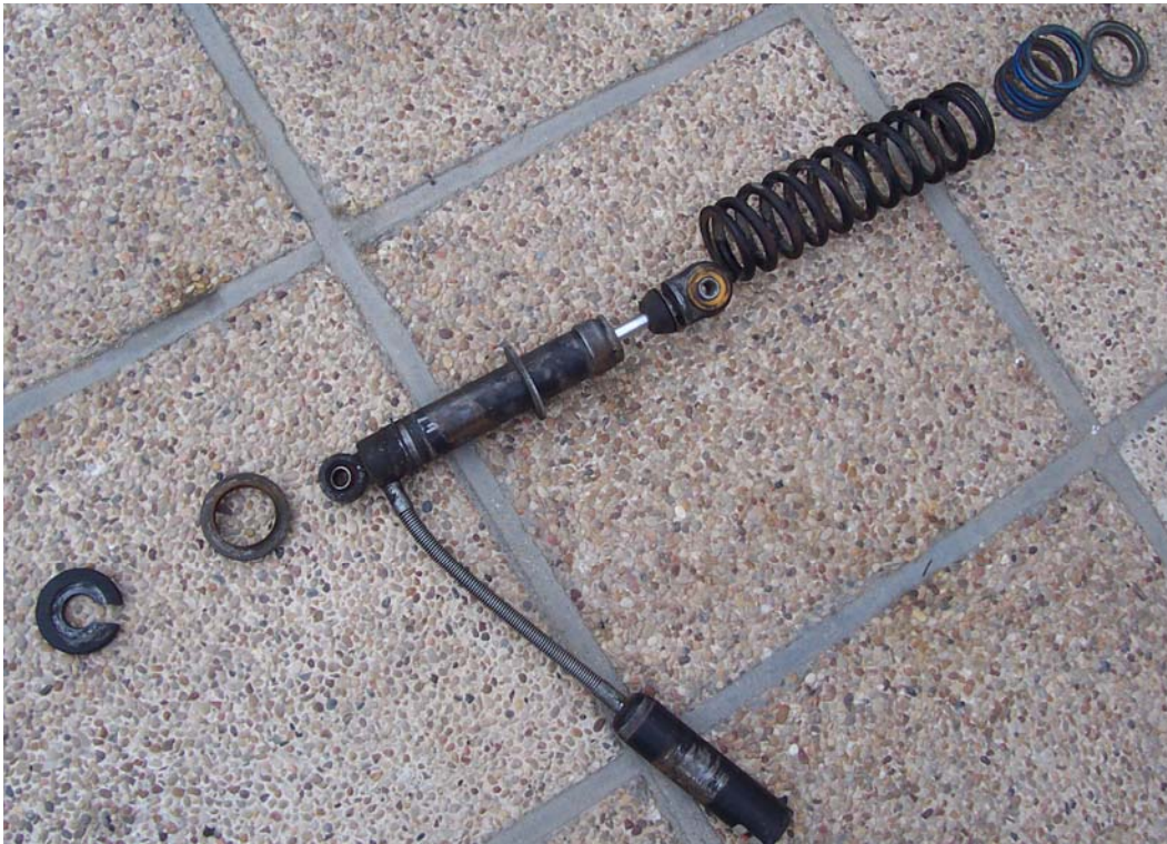
Conjunto de muelles ya desmontados.
